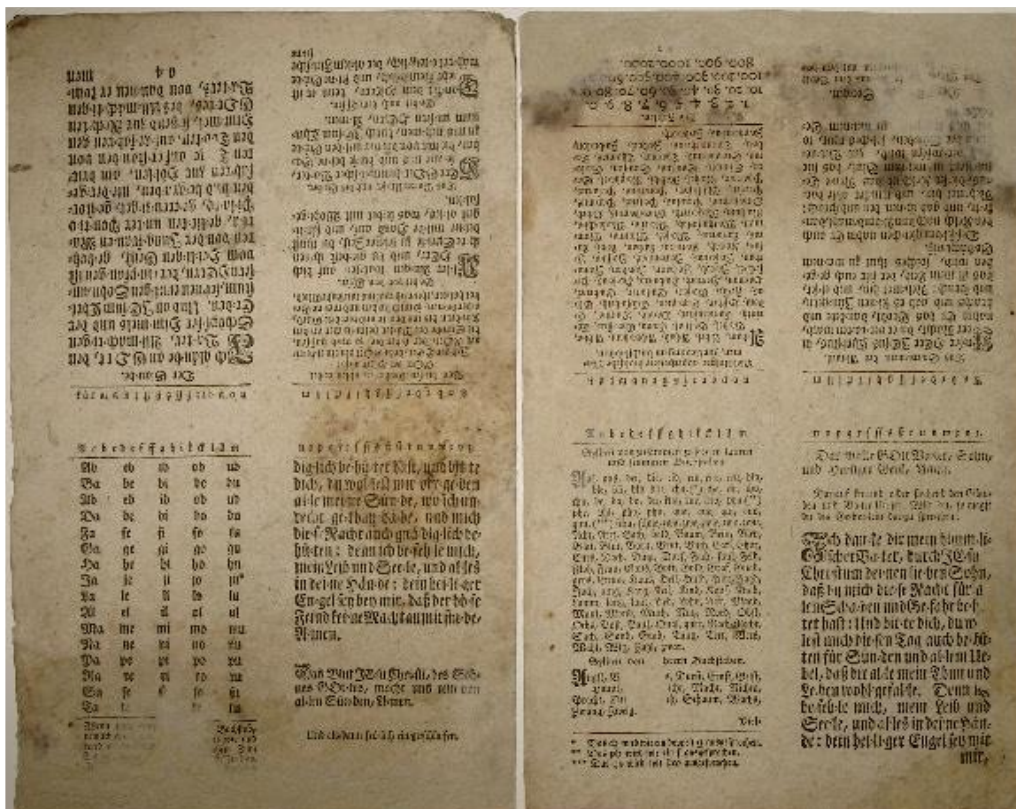
Der obere Bogen zeigt die Seiten 1, 4 und 5, 8 und 9, 12 und 13, 16, der untere Bogen die Seiten 2 und 3, 6 und 7, 10 und 11, 14 und 15. Die beiden Bögen entsprechen den beiden Druckstöcken.
